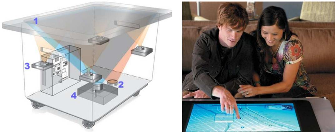
**Abbildung 2.21:** Links: Aufbau eines Microsoft Surface. Rechts: Routenplanung am Surface.<sup>33</sup>
