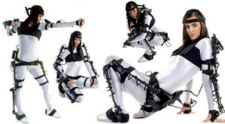
**Abbildung 2.9:** Ansichten eines mechanischen MoCap-Anzugs mit Exoskelett.<sup>16</sup>
