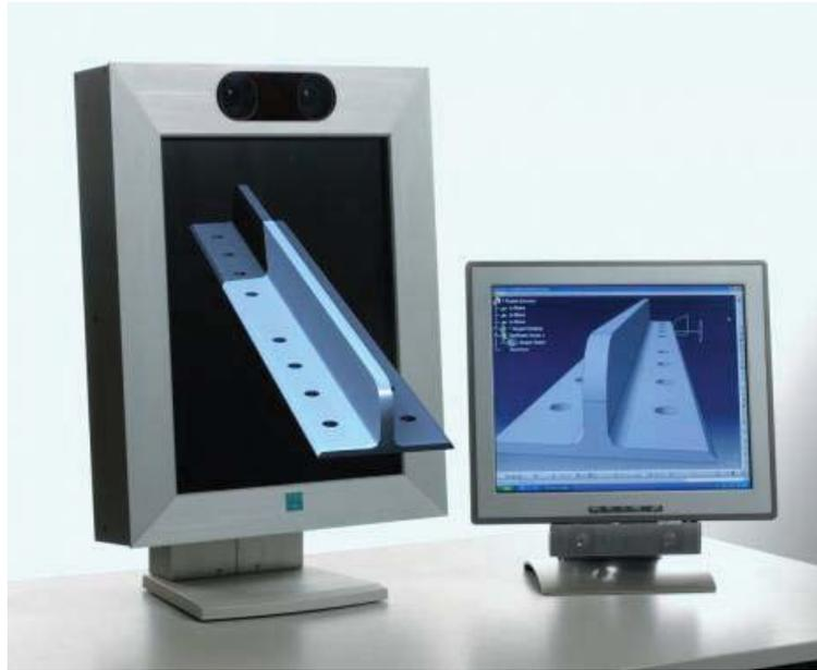
**Abbildung 6.11:** Autostereoskopisches Display Free2C Desktop vom Fraunhofer HHI.
