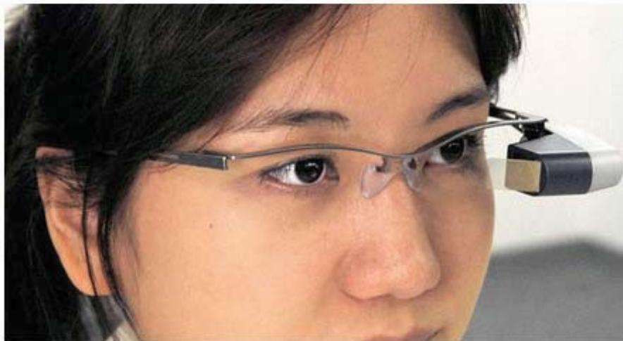
**Abbildung 6.17:** Von Brother entwickeltes Retinal Image Display. ©Brother
