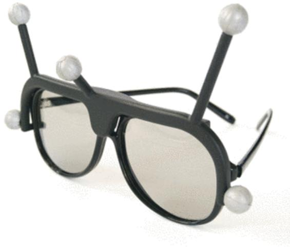
**Abbildung 6.14:** Trackbares Brillentarget, entwickelt von IMSYS. ©IMSYS
