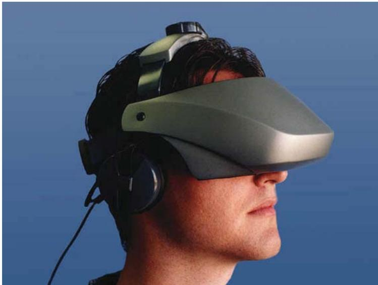
**Abbildung 3.18:** Beispiel eines Head Mounted Displays. ©Fifth Dimension Technologies
