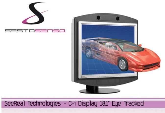
**Abbildung 6.12:** Autostereoskopisches Display C-i 18 von Seereal inklusive Tracker-Kameras. ©Seereal
