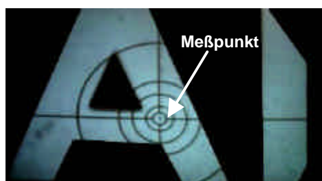
Bild 2-2. Anvisierter Meßpunkt auf dem Monitor
