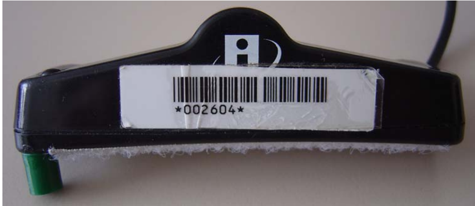
Abb. 34: Head-Tracker der Firma InterSense (Länge: 7cm)
