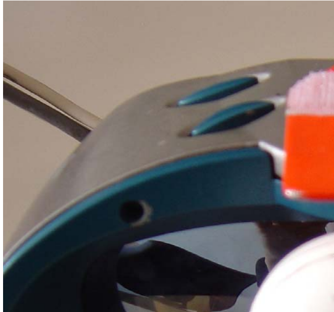
Abb. 29: Tasten zur Steuerung der AR-Anwendung an der AR-Brille
