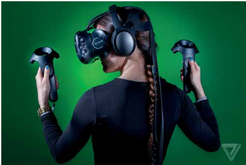
Abbildung 2.7: Das VR-System Vive von HTC besteht aus einem Head-Mounted-Display, zwei Handcontrollern und zwei Tracking-Stationen, um die Position des Spielers verfolgen zu können ( https://www.theverge.com/2016/4/5/11358618/htc-vive-vr-review Stand 28.09.2020).
