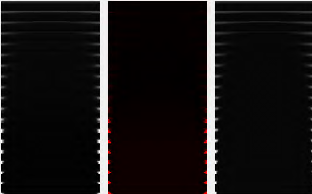
Abbildung 4.8: Links: Die Messdaten als Textur. Rechts: Die Modelldaten mit approximierten Parameterwerten. Mitte: Die Differenz zwischen beiden.
