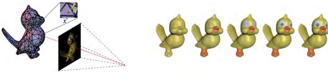
Abbildung 3.2: Links: Zusammenhang zwischen Pixel-Position der Aufnahme und Punkt-Position des 3D-Modells wodurch die Normale jedes Dreiecks berechnet werden kann. Rechts: Das Reflexionsverhalten des Modells aufgeteilt in Clustern [LKG + 01].
