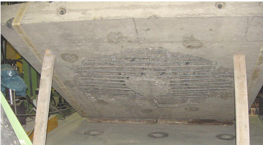
Bild 4.11.1: Durchstanzbereich - 1,5 \times d -
