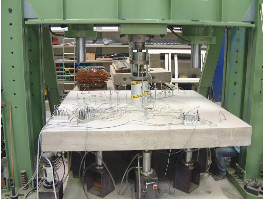
Bild 3.1.1: Versuchsaufbau zur Untersuchung von Innenstützen
