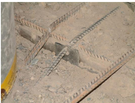
Bild 4.8.2: Versagen der Umschnürung und Grundbewehrung
