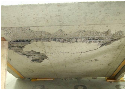
Bild 4.16.1: Abplatzungen der Betondeckung im Durchstanzkegel
