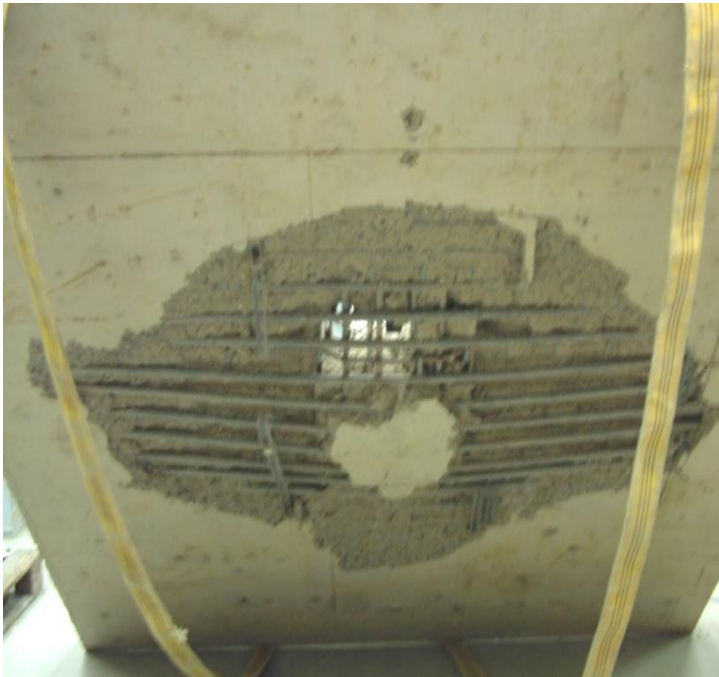
Bild 4.8.1: Durchstanzbereich -kreisförmig ausgebildet-
