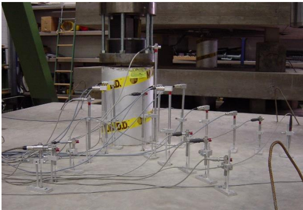
Bild 3.2.1: Wegaufnehmer an der Oberseite der Platte
