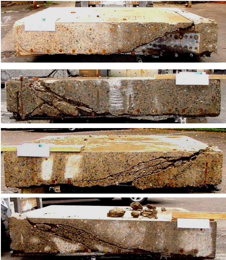
Bild 4.3: Durchstanzkegel Versuchskörper C
