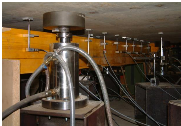
Bild 3.2.2: Wegaufnehmer an der Unterseite der Platte
