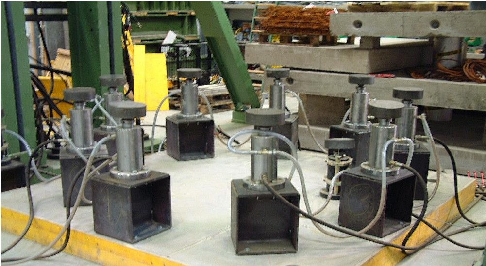
Bild 3.1.2: Anordnung der hydraulischen Einzelzylinder zur Erzeugung der Belastungen
