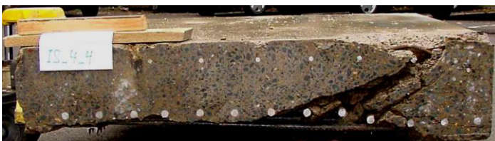
Bild 4.2: Durchstanzkegel Versuchskörper B
