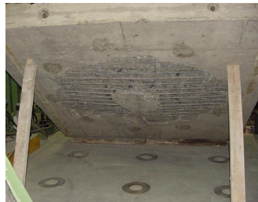
Bild 5.3.8: Durchstanzkegel Körper M
