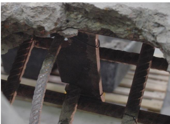
Bild 4.13.2 und 4.13.3: Unverformte Einbauteile
