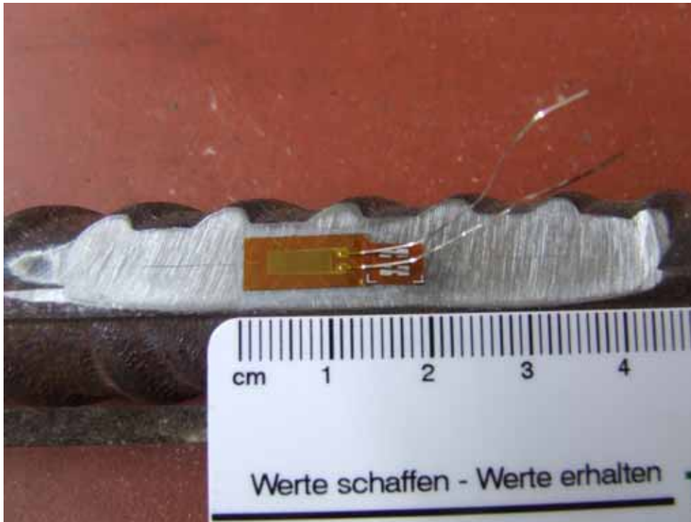
Dehnungsmessstreifen auf der Bewehrung
