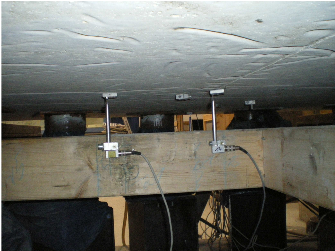
Wegaufnehmer oben zur Messung der Plattendicke
