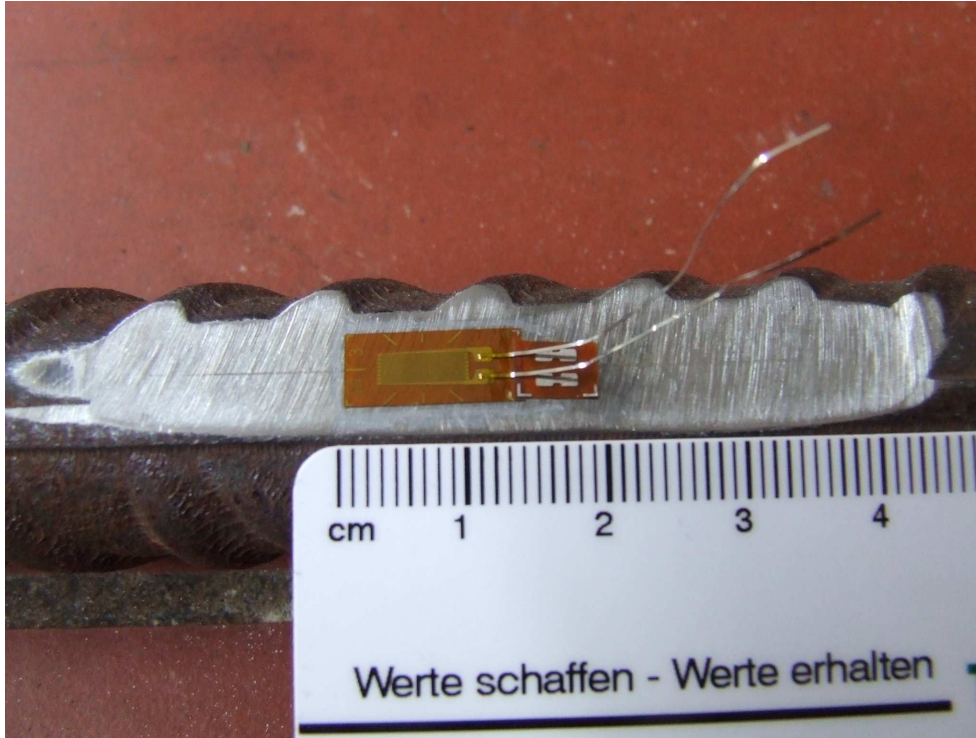
Dehnungsmessstreifen auf der Bewehrung
