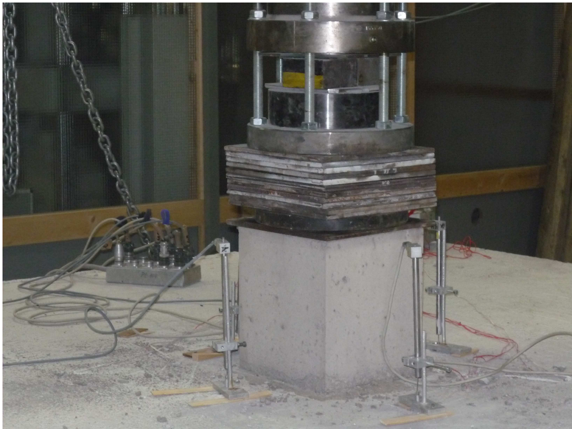
Wegaufnehmer oben zur Messung der Plattendicke
