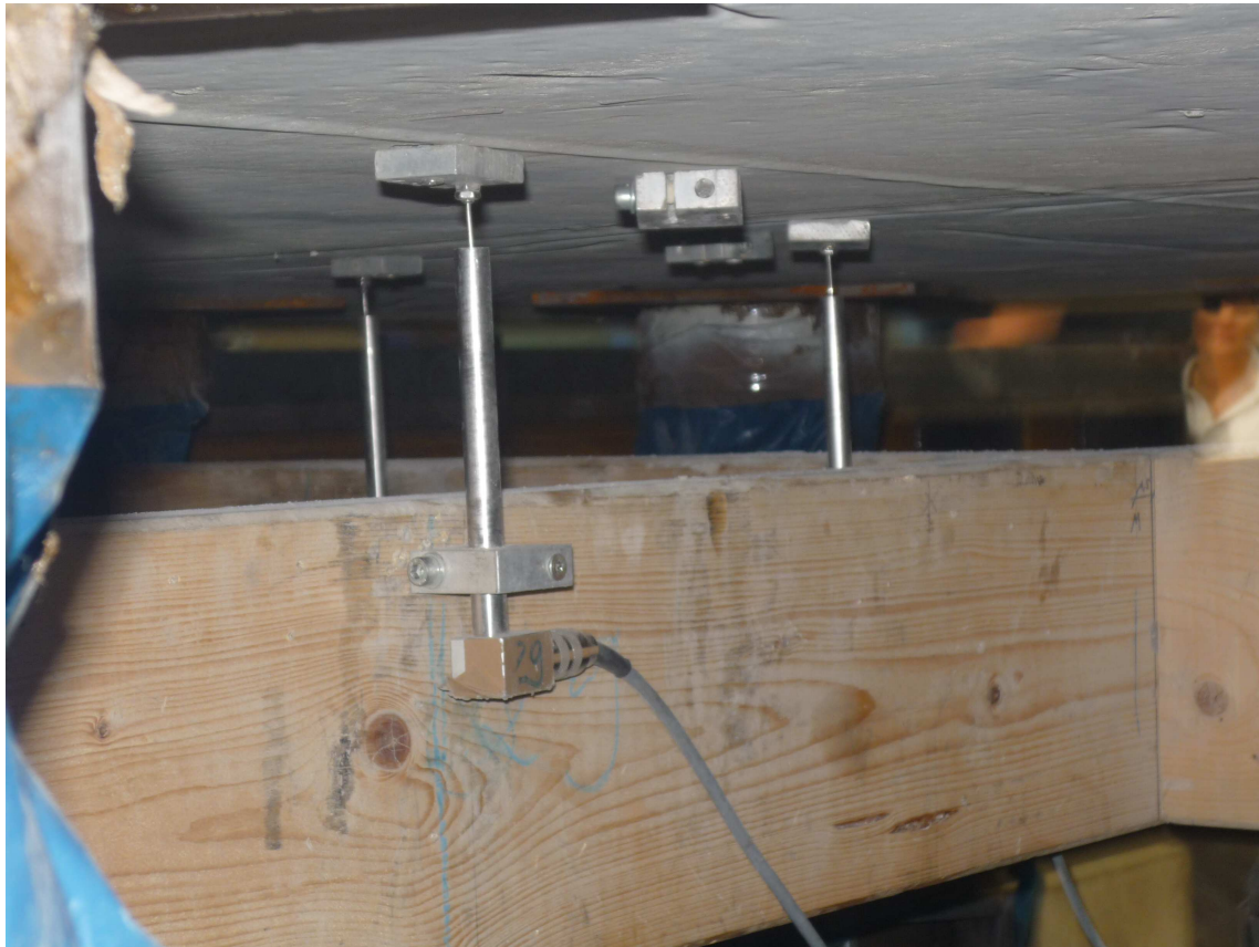
Wegaufnehmer oben zur Messung der Plattendicke
