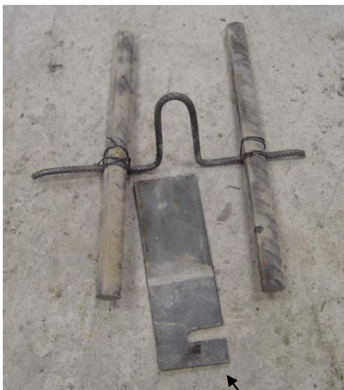
Verformung im Bereich des Langloches
