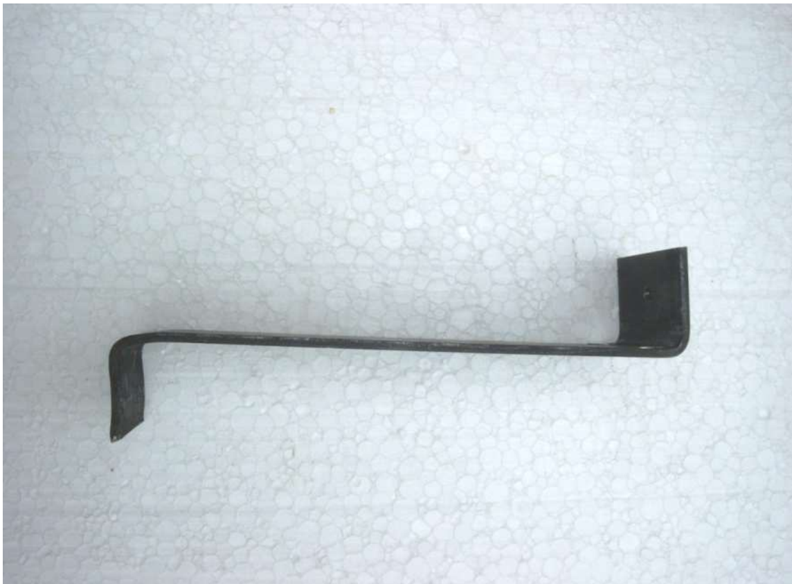
Einbauteil – einfach gekantet - Versuchskörper BL
