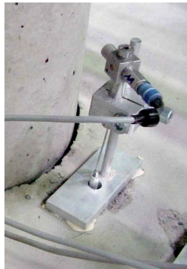
Wegaufnehmer zur Messung der Plattendicke
