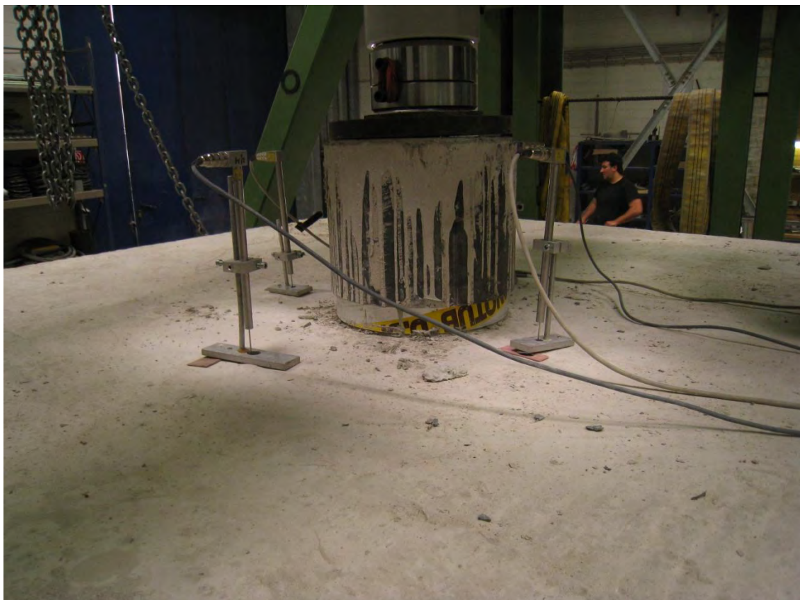
Wegaufnehmer oben zur Messung der Plattendicke
