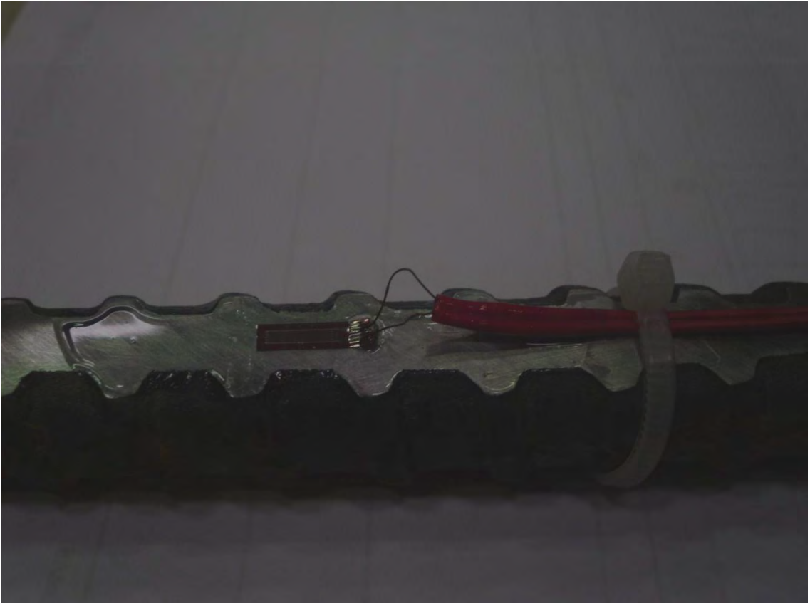
Dehnungsmessstreifen auf dem Spann Stahl
