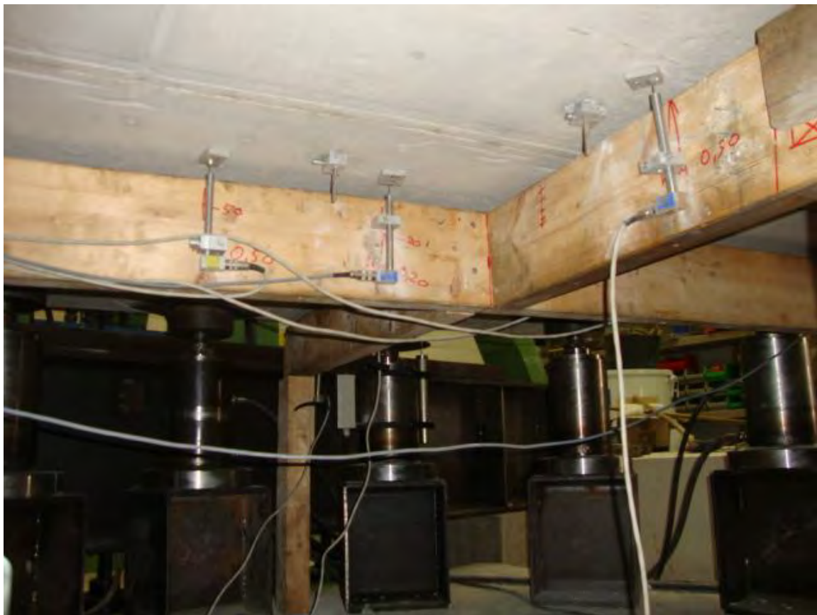
Wegaufnehmer oben zur Messung der Plattendicke
