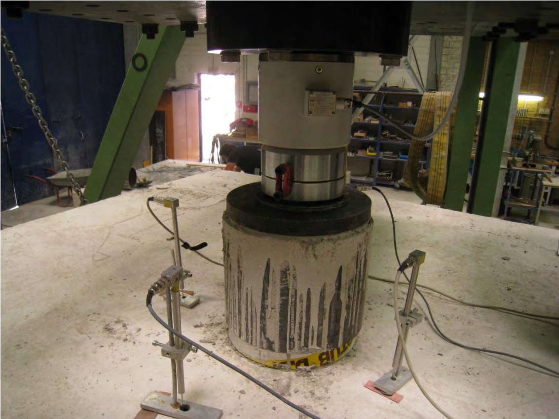
Wegaufnehmer oben zur Messung der Plattendicke
