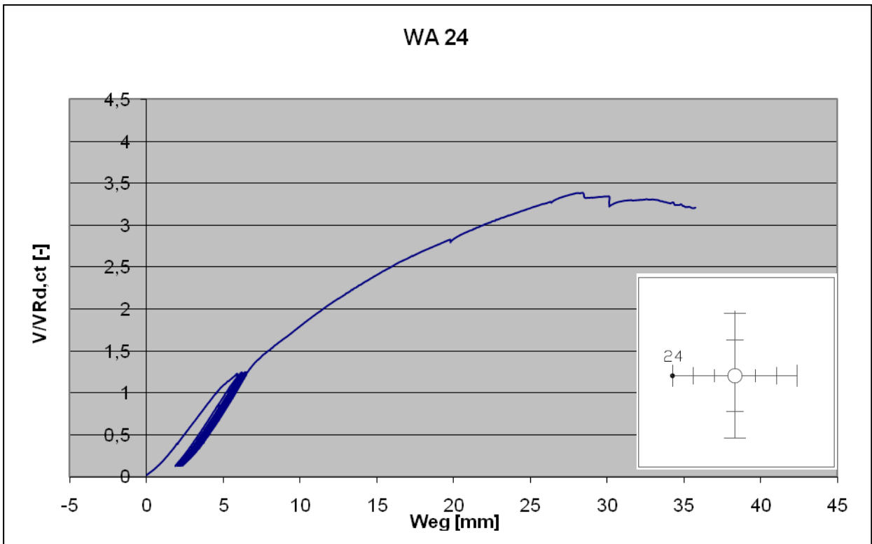
Messung der Durchbiegung von Versuchskörper MC am Wegaufnehmer WA 24
