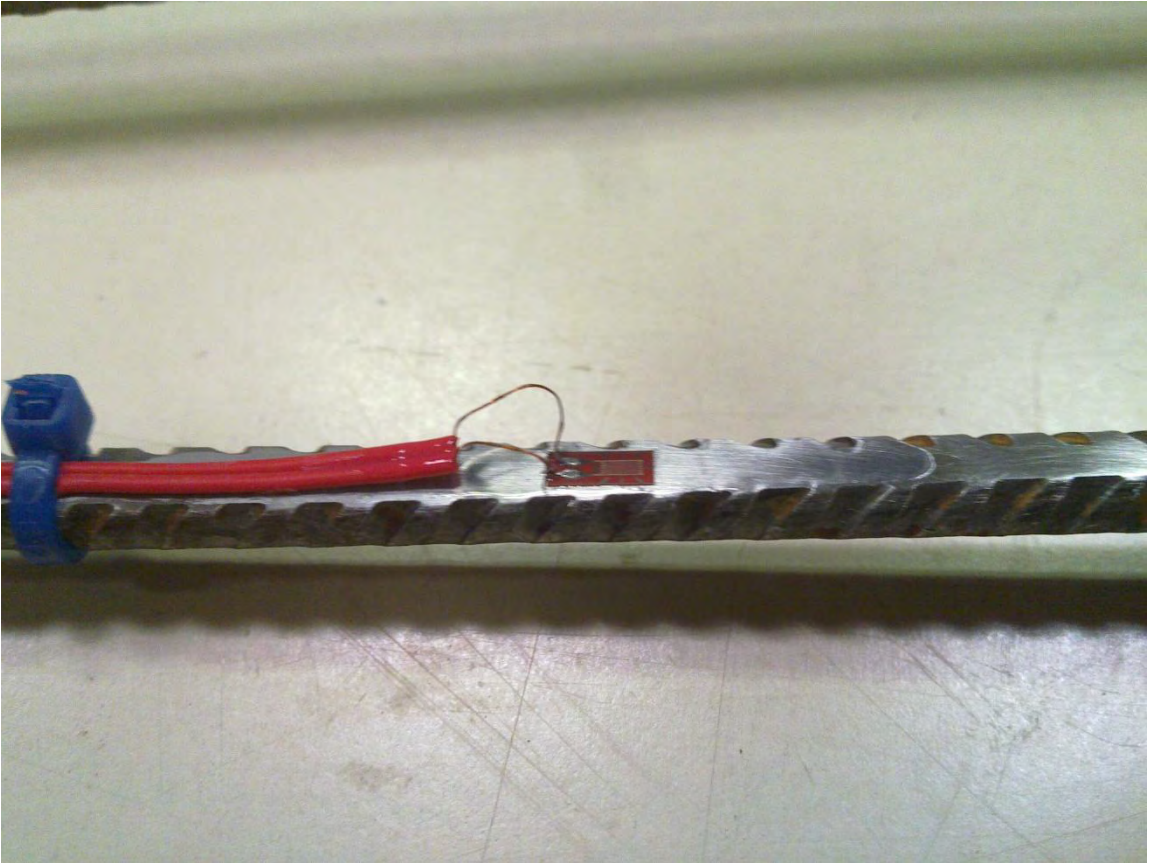
Dehnungsmessstreifen auf dem Spannstahl
