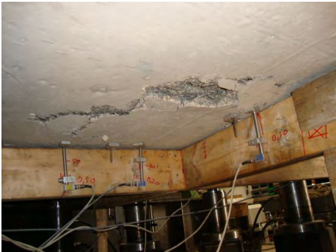
Wegaufnehmer oben zur Messung der Plattendicke
