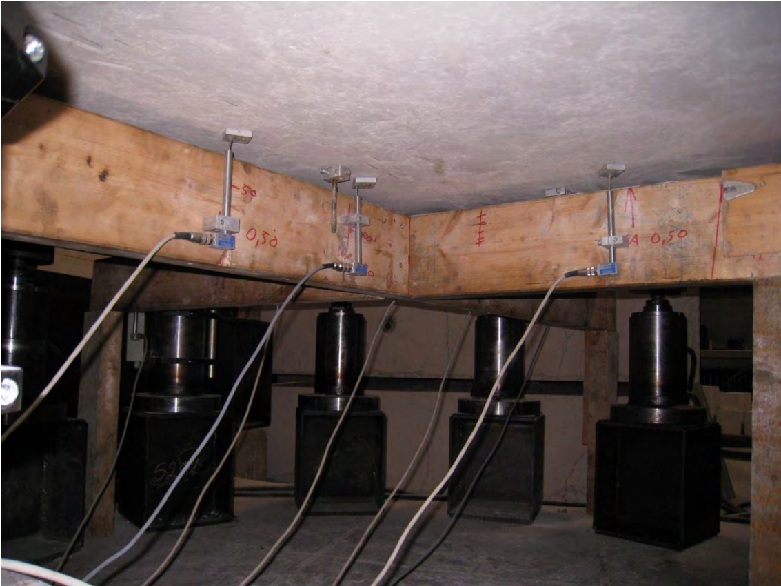
Wegaufnehmer oben zur Messung der Plattendicke
