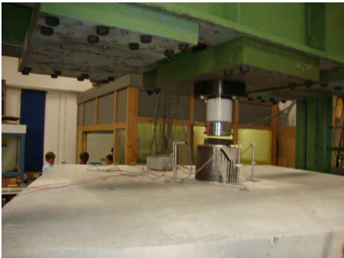
Wegaufnehmer oben zur Messung der Plattendicke
