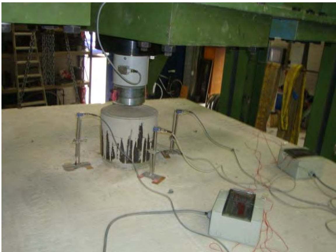
Wegaufnehmer oben zur Messung der Plattendicke
