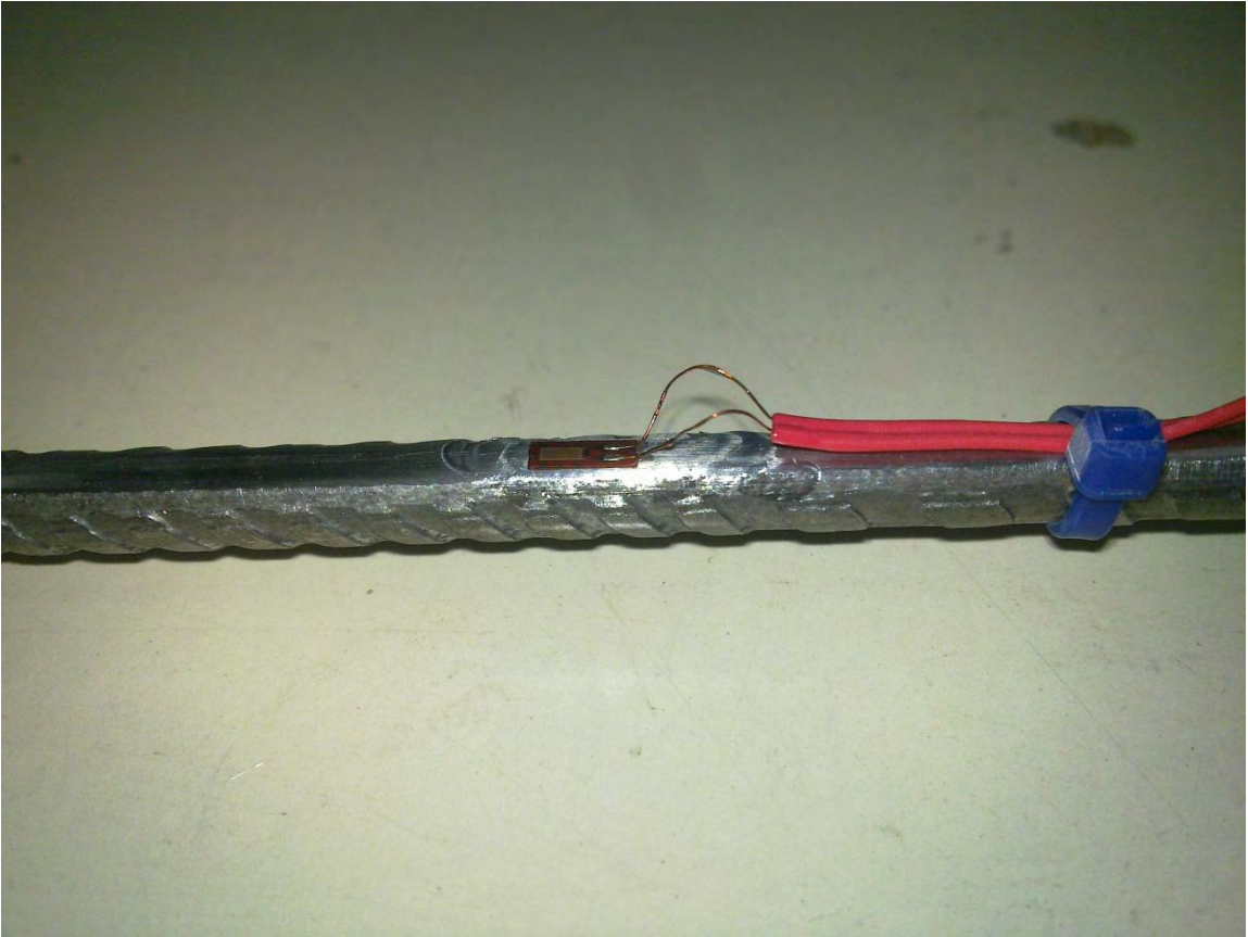
Dehnungsmessstreifen auf dem Spannstahl
