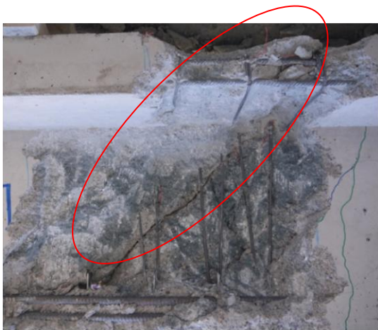
Schrägriss in der Druckzone – Körper BA4
