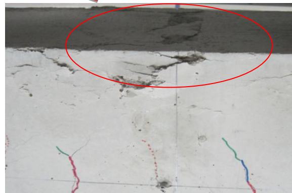
Betondruck-Versagen – Körper AA3
