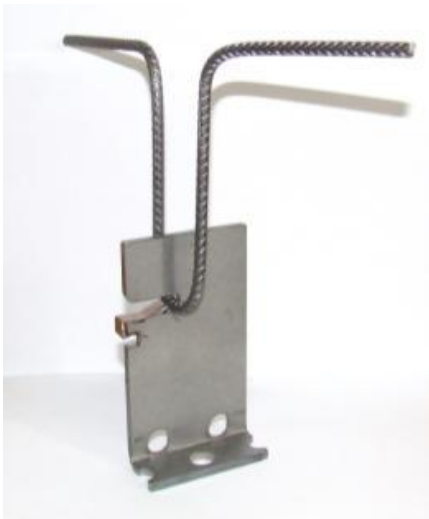
Abb.28: L-Blech mit zweischnittigem Bügel
