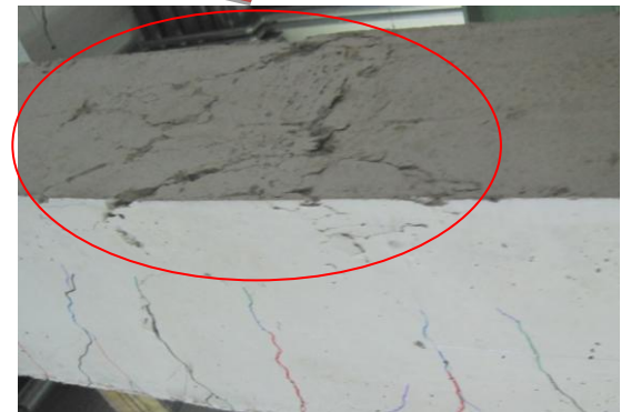
Betondruck-Versagen – Körper AA4
