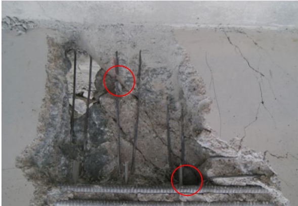
Zugversagen der Bügelbewehrung – Körper BB5
