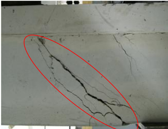
Der Schrägriss weitet sich auf – Körper BB5
