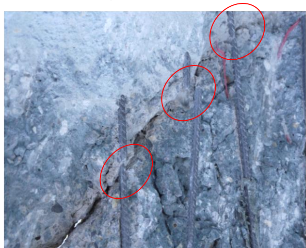
Zugbruch der Bügel (L-Blech) – Körper BA4
