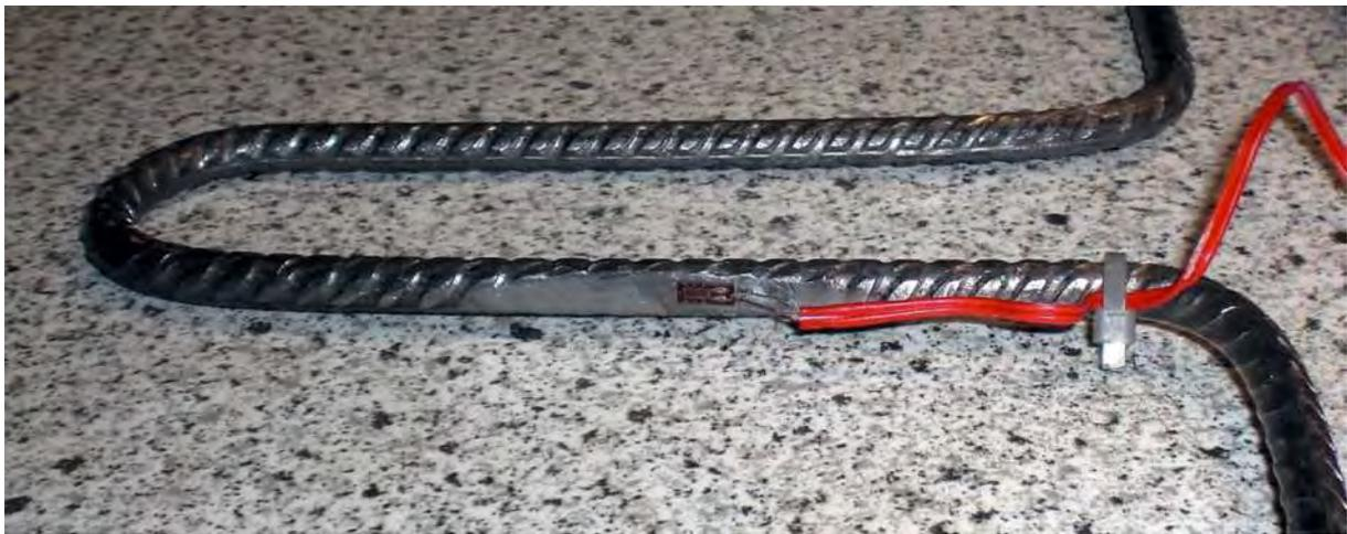
Dehnmessstreifen auf dem Bügel
