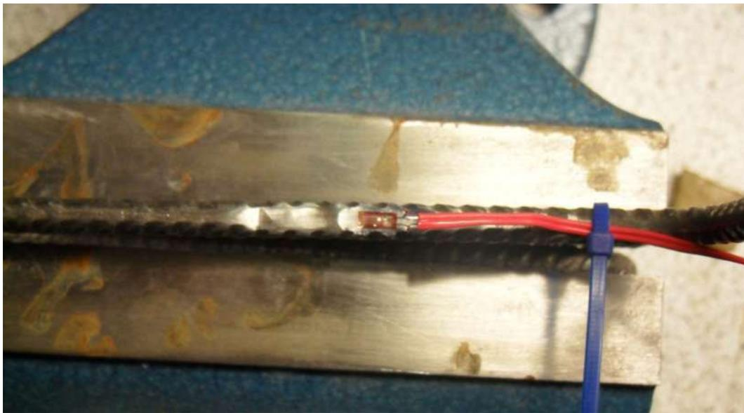
Dehnmessstreifen auf dem Bügel
