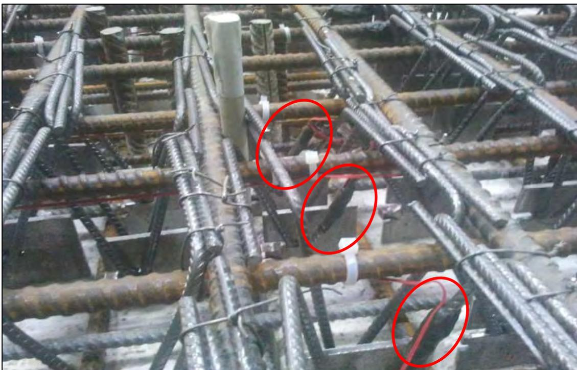
Dehnmessstreifen am Bügel in Einbaulage
