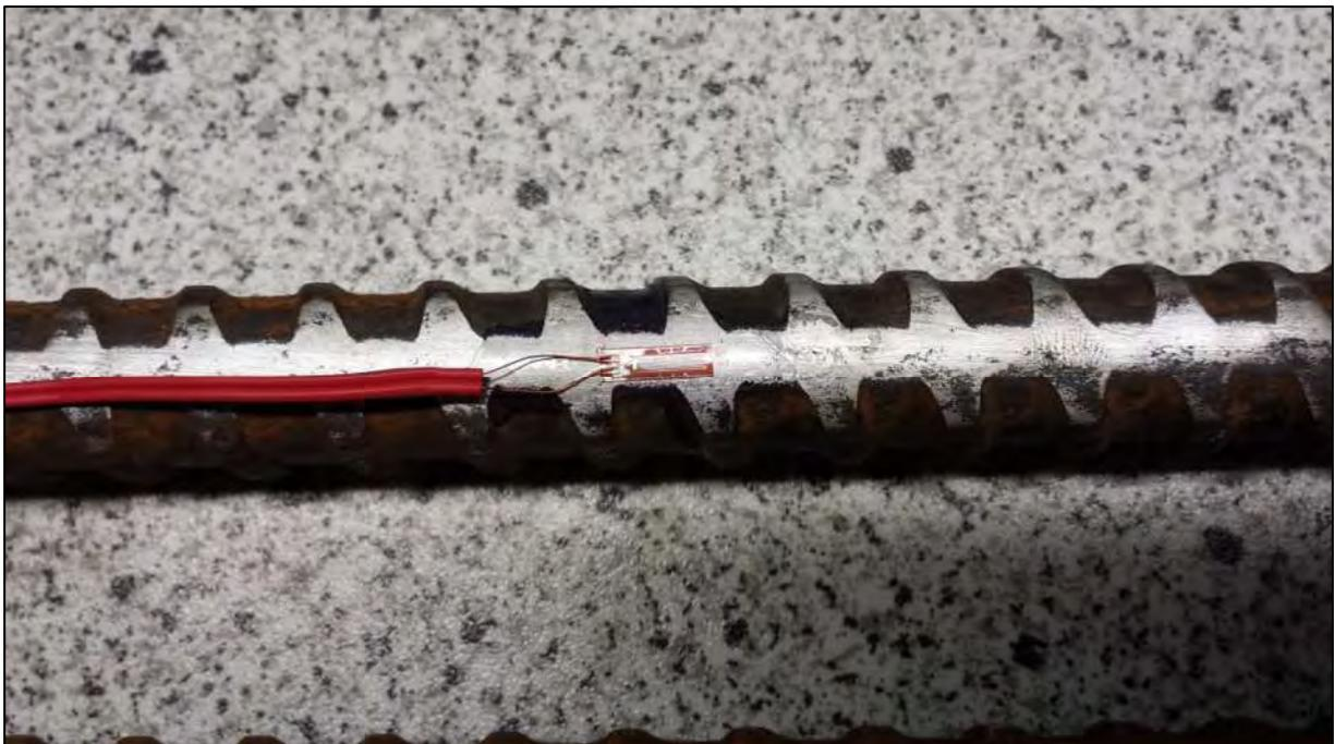
Dehnmessstreifen auf dem Spannstahl
