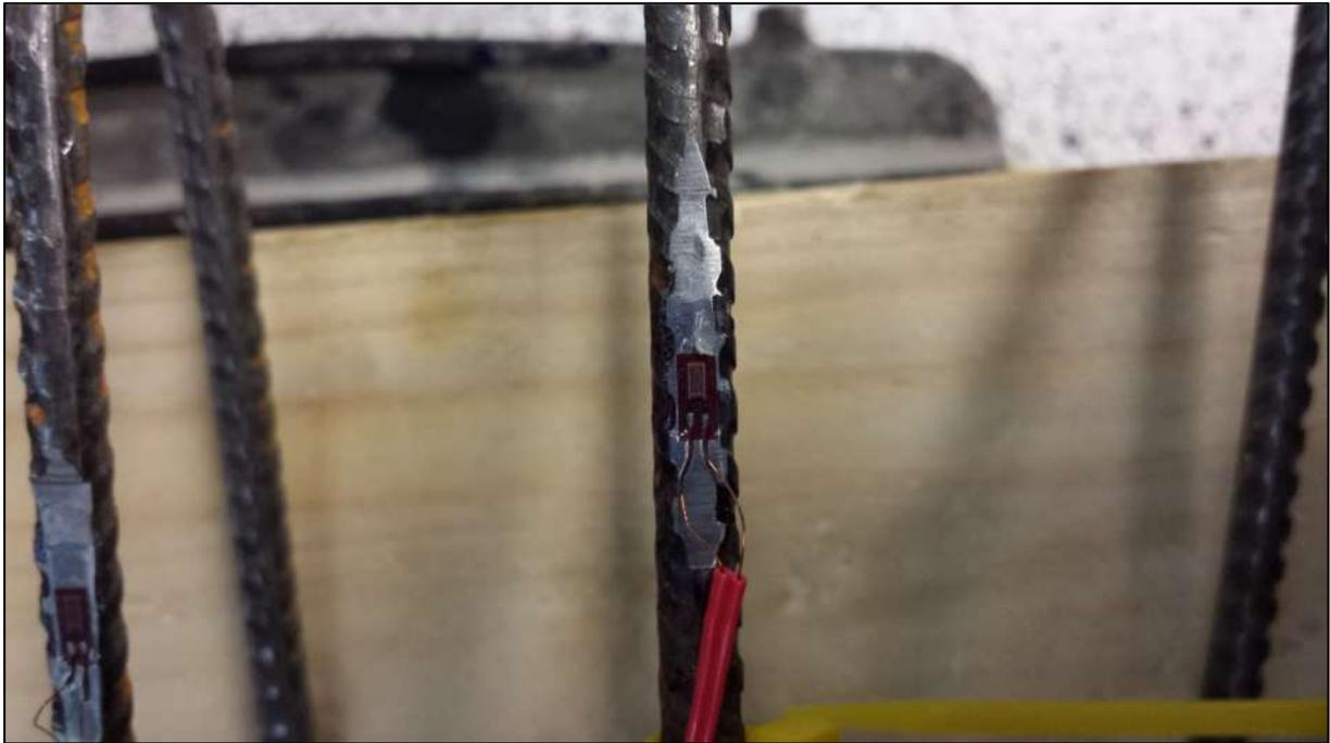
Dehnmessstreifen auf dem Bügel
