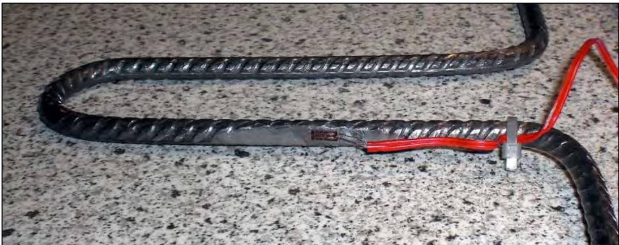
Dehnmessstreifen auf dem Bügel
