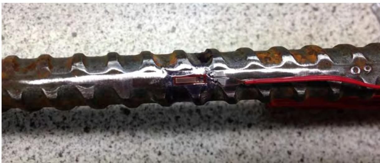
Dehnmessstreifen auf dem Spannstahl
