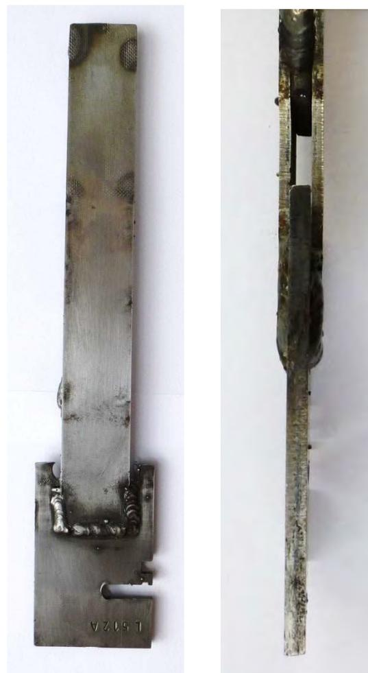
Abb. 2 bis 3: Bleche nach dem Schweißen
