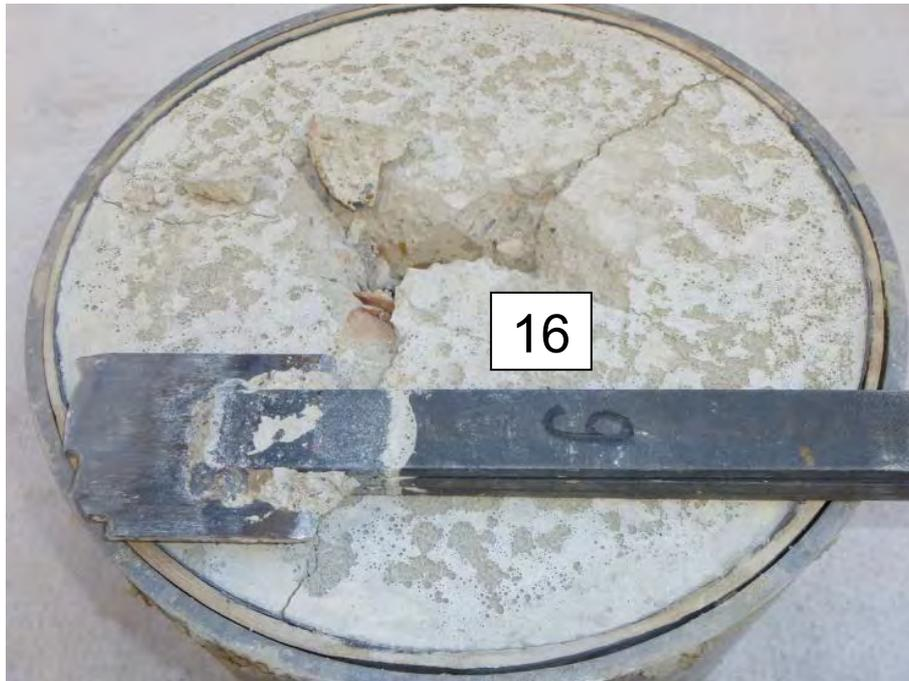
*Prüfkörper L16 nach dem Versagen*
