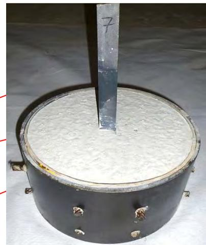
Abb. 5: Prüfkörper betoniert L1 – L16: Ortbetonschicht (links), mit Fertigteilschicht (rechts)
