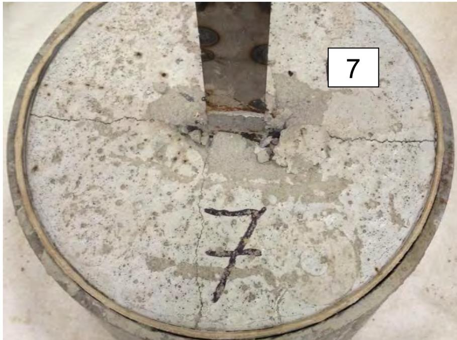
*Prüfkörper L7 nach dem Versagen*
