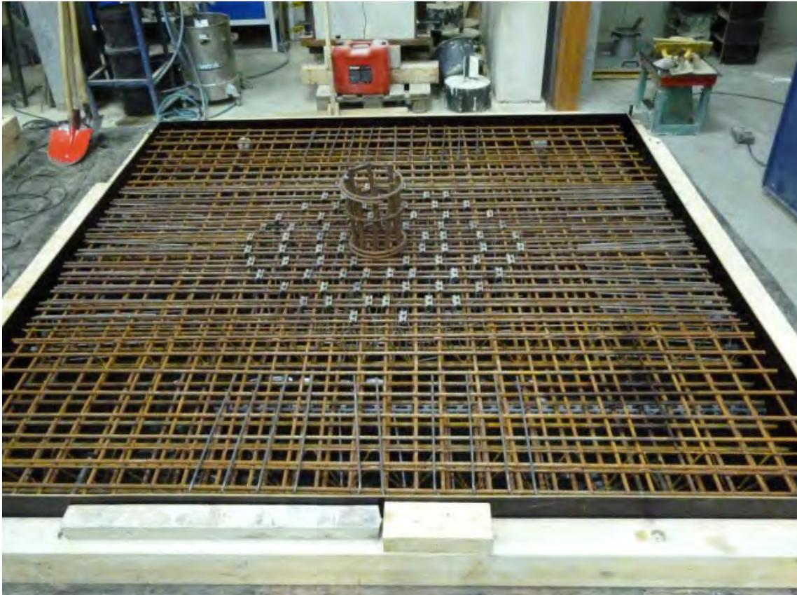
Abbildung 1.2: Versuchskörper in der Schalung
