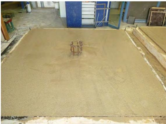
Abbildung A10: Vollständig betonierte Platte
