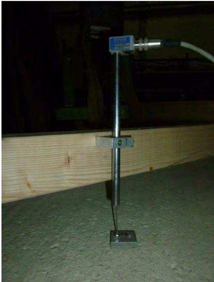
Abbildung A16: An der Holzkonstruktion befestigte Wegaufnehmer
