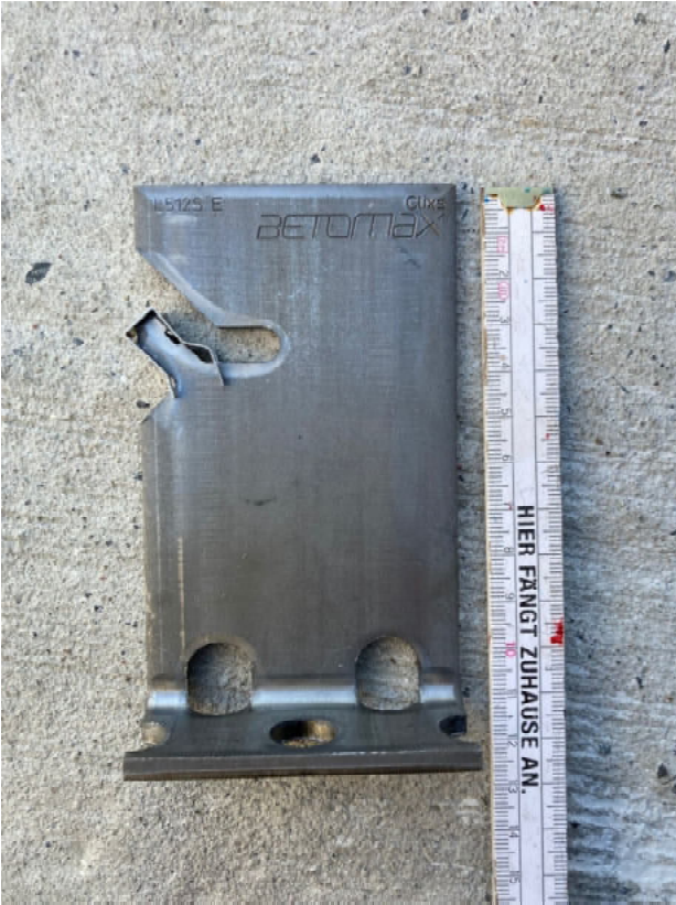
Abbildung 7: L-Blech mit Clip
