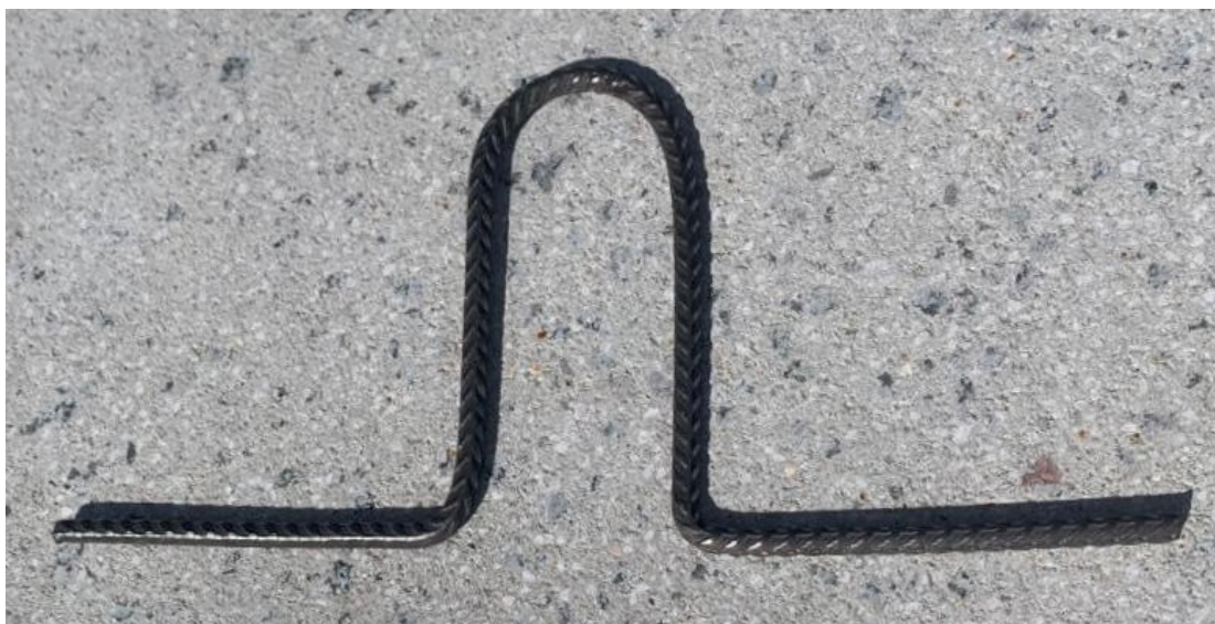
Offener Bügel Ø 6 mm
