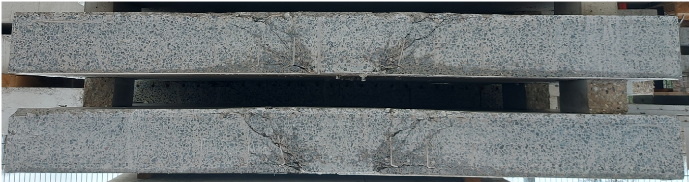
Rissverlauf im Schnitt
