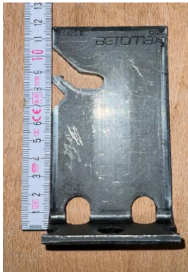
Abmessung der L-Bleche
