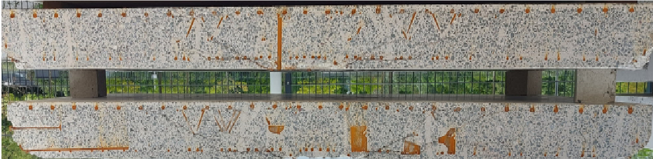
Rissverlauf im Schnitt
