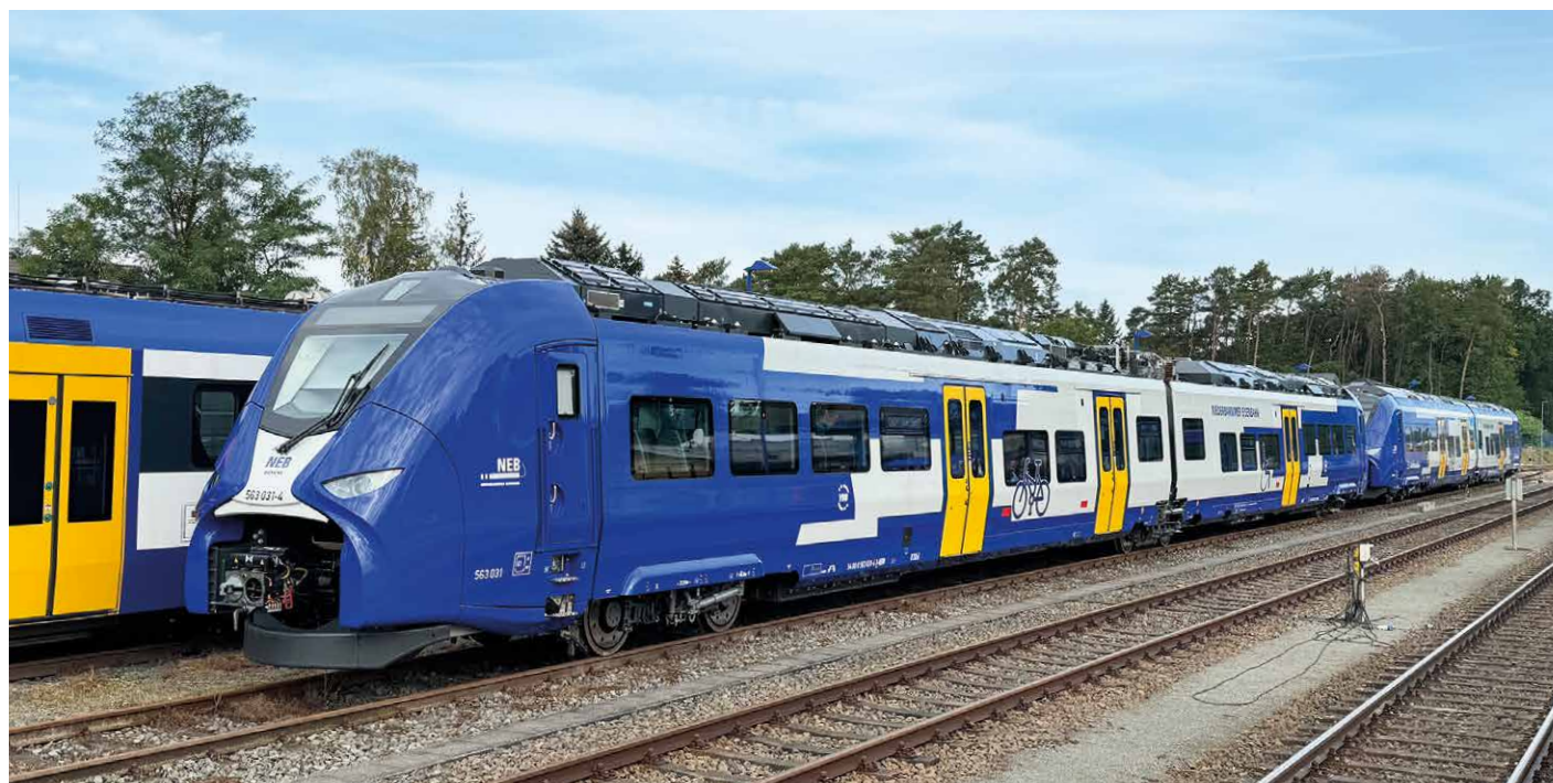
Optisch unterscheiden sich die beiden Zugtypen nur durch die verschiedenen Dachaufbauten sowie durch die unterschiedlich hoch angeordneten Einstiege – vorne ein batterie-elektrischer Mireo Plus B, hinten der Wasserstoffzug Mireo Plus H.
