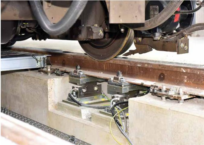
Unscheinbare Messinstrumente im Wartungsgleis dienen der Erfassung der jeweiligen Radsatzlast bei der Überfahrt und damit der Messung der exakten Fahrzeugmasse.
