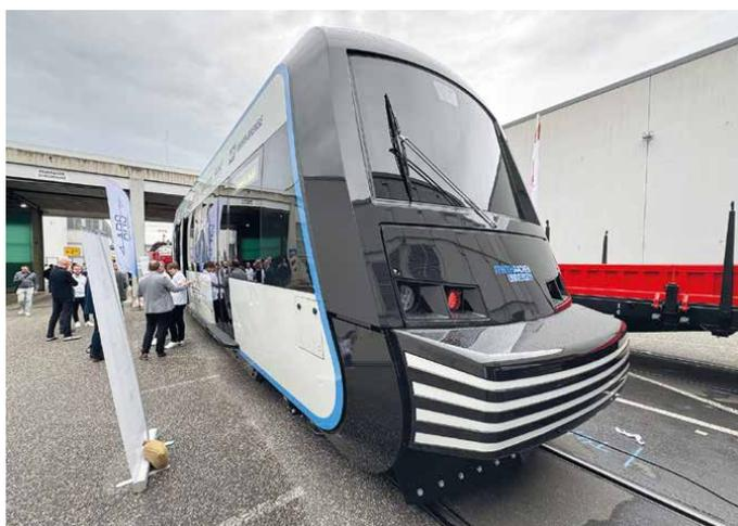
Auf der Berliner InnoTrans 2024 hatte der batterie-elektrisch angetriebene Aachener Rail Shuttle (ARS) Premiere.
