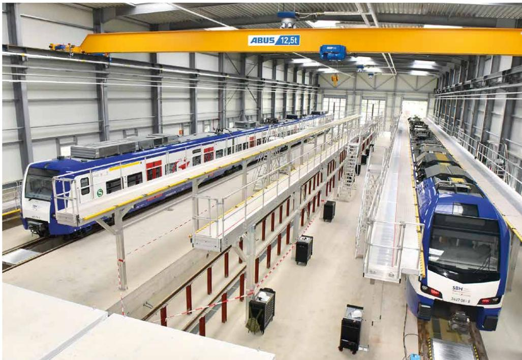
Zwei der drei Hallengleise in Celle sind mit Dacharbeitsständen von MUNK Günzburger Steigtechnik ausgestattet. Alle Gleise sollen noch mit Oberleitungen versehen werden. Links ein Triebzug der Baureihe 425.2, rechts ein Stadler FLIRT.
